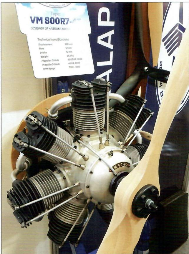
Pár údajů o motoru VM 800 R7 na stánku firmy Fiala, který mají naši modeláři málokdy možnost vidět. Hmotnost je okolo 28 kg, sedm válců o vrtání 52 mm, objem 800 ccm, maximální otáčky 3600 ot/min. V případě použití na Fokkeru Dr. 1 se používá s dvoulistou vrtulí 59x20" a otáčky se pohybují do 2600
